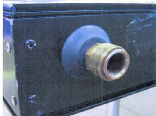
Ansicht der Gehäusedurchführung des Sammelrohres und des Rohranschlusses view of frame-feedthrough of header tube and of the tube connection
