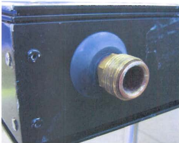
Ansicht der Gehäusedurchführung des Sammelrohres view of frame- feedthrough of header tube
