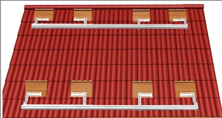
En cas de fixation de 2 ou 3 panneaux, les ancrages d'extrémité pourront être espacés de 15 à 30 cm de l'extrémité du rail, les rails intermédiaires se positionneront approximativement à la jonction de panneaux
