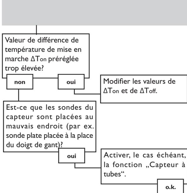
La différence de température entre le réservoir et le capteur augmente lorsque le système est en marche; le circuit capteur ne peut pas dissiper la chaleur.
