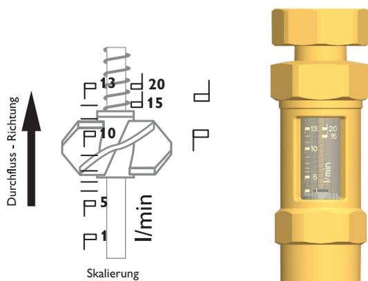
Le FlowCheck sert à la mesure et l'affichage du débit de 1 à 20 l/min. Afin de garantir un fonctionnement correct de l'appareil de mesure, l'installation doit être rincée et exempte de corps étrangers. .
