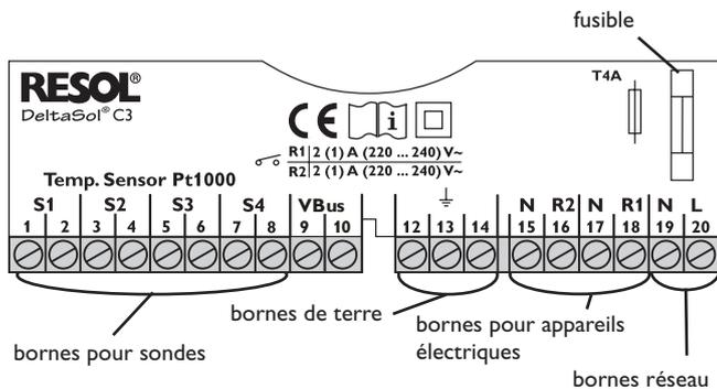
L'alimentation électrique du régulateur doit passer par un interrupteur de réseau externe (dernière étape de montage!) et la tension d'alimentation doit être comprise entre 220...240 V~ (50...60 Hz). Fixer les câbles sur le boîtier à l'aide des serre-fils inclus dans le matériel de montage et des vis correspondantes ou les placer dans une goulotte jusqu' au boîtier de la régulation.
