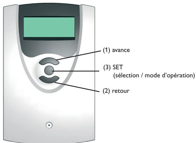
1. Brancher l'appareil sur secteur. Le régulateur met en marche une phase d'initialisation dans laquelle le témoin lumineux clignote en vert et en rouge. Après cette phase d'initialisation, le régulateur passe au mode de fonctionnement automatique avec les réglages d'usine. Le schéma de système pré-réglé est Inst 1\*.
