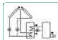
Système de chauffage solaire avec panneaux solaires est/ouest et chaudière combustible solide
