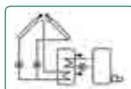
Système de chauffage solaire avec panneaux solaires est/ouest et chauffage d'appoint thermostatique
